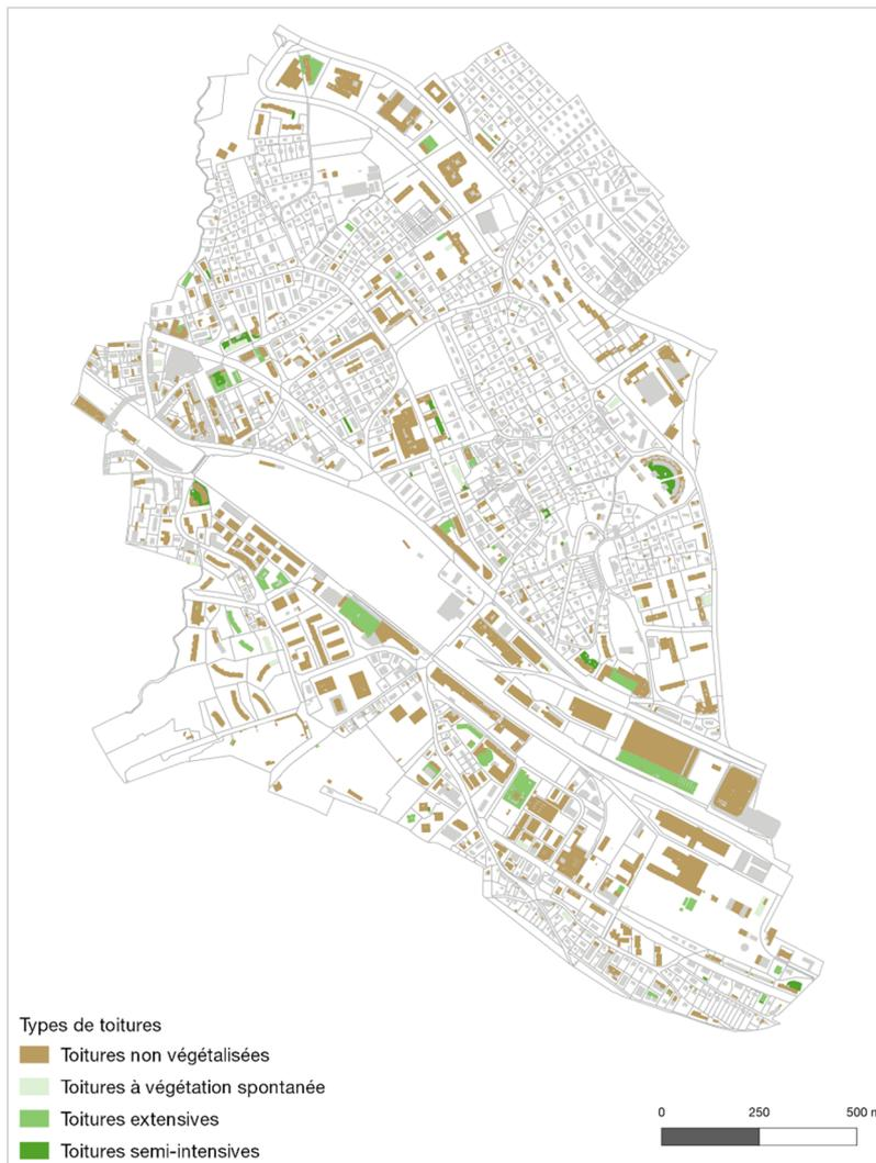
Figure 34 : Cartographie des toitures végétalisées<sup>92</sup>
