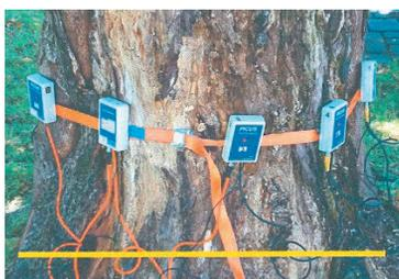
La tomographie permet une analyse de l'état interne de l'arbre par envoi d'ondes sonores à travers le tronc
