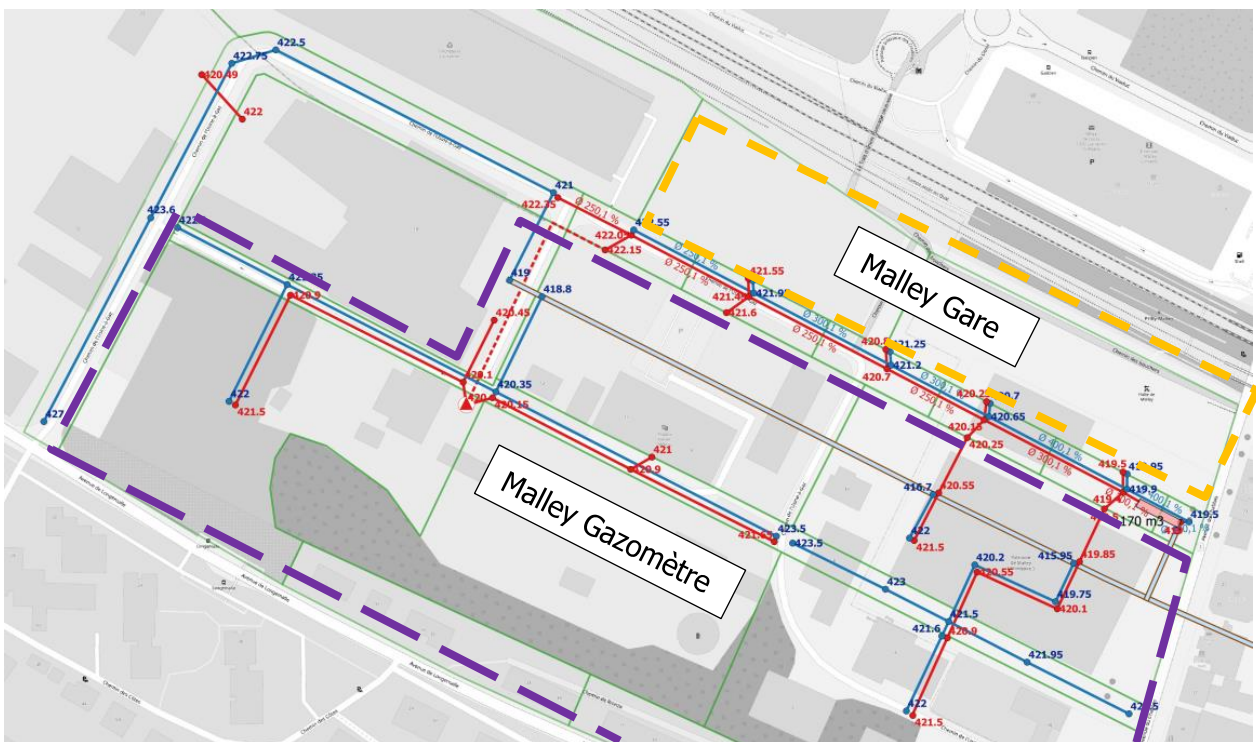
Concept d'évacuation des eaux (variante retenue), Holinger, 2020
