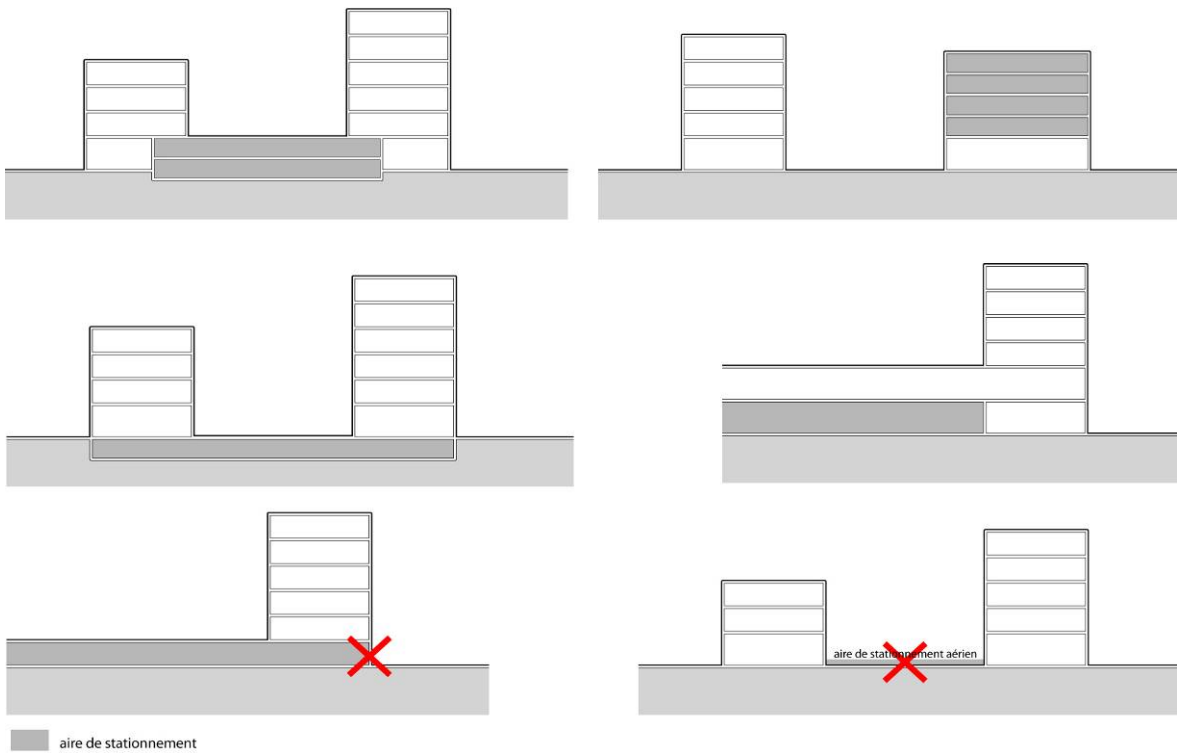
Préconisations en termes d'intégration des aires de stationnement
